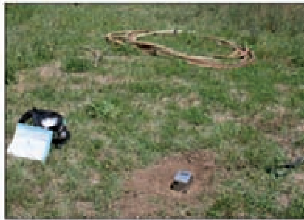
Fig. 3 - Nel pannello di sinistra è possibile osservare la disposizione dei sensori realizzata per un'antenna sismica a geometria lineare. Nel pannello di destra, invece, è visualizzato un unico sensore utilizzato per la metodologia d'indagine definita a "stazione singola".
