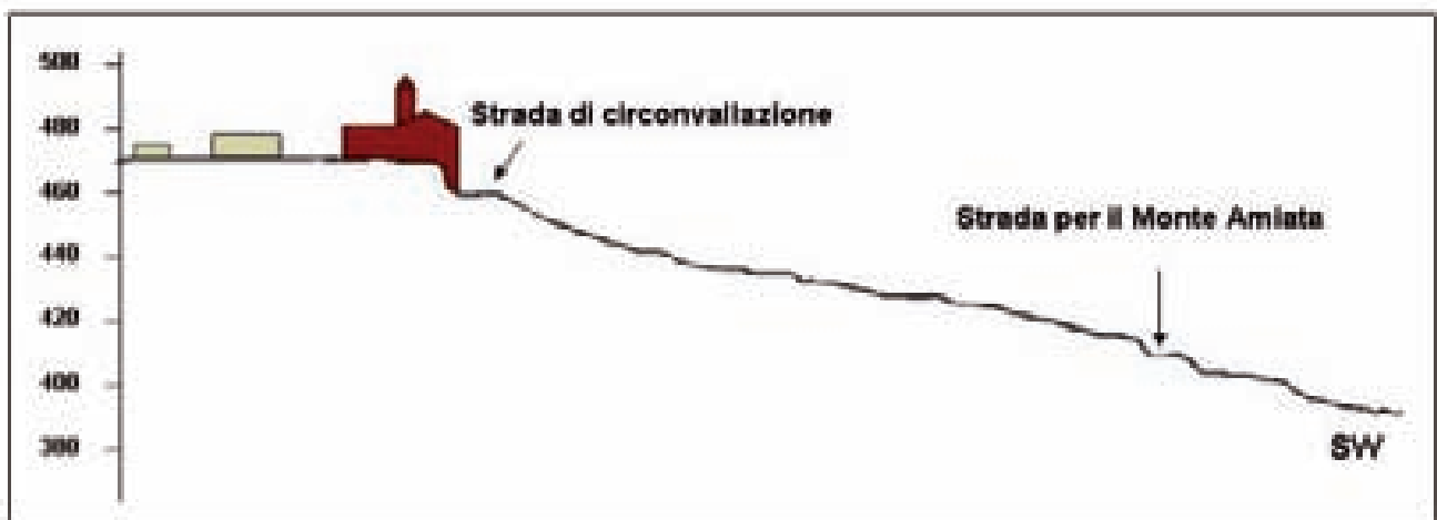
Fig. 1 - Profilo topografico del versante meridionale della collina su cui insiste il centro storico di Pienza interessata dalla campagna di misure geofisiche. Le quote sono indicate in metri sul livello del mare.
