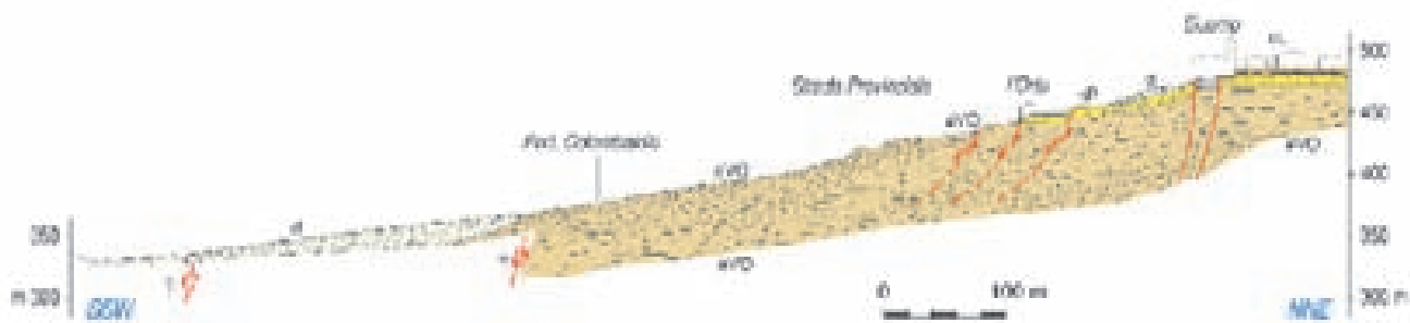
Fig. 20 - Sezione geologica trasversale al versante meridionale di Pienza. In rosso sono indicate le faglie rilevate o riconosciute con la fotogeologia. Spiegazione delle sigle: d – detrito superficiale; cL – Calcare organogeno a Lithothamnium e ad Amphistegina ; sP – Sabbie gialle ed arenarie di Pienza e S. Quirico; aVO – Argille della Val d'Orcia.
