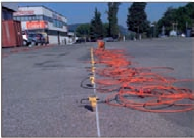
Fig. 3 - Nel pannello di sinistra è possibile osservare la disposizione dei sensori realizzata per un'antenna sismica a geometria lineare. Nel pannello di destra, invece, è visualizzato un unico sensore utilizzato per la metodologia d'indagine definita a "stazione singola".
